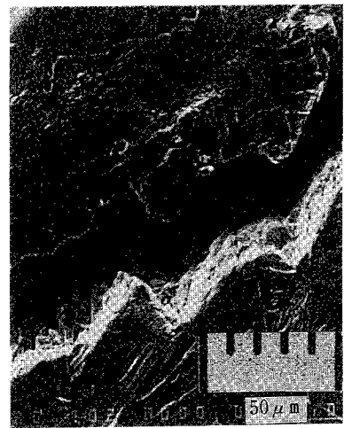
写真-3 微視き裂進展挙動
