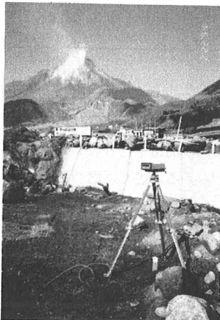
写真－1 G P S 静止測量実施状況
