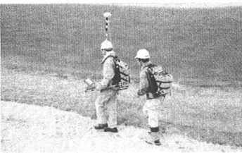
写真-4 平面完成測量状況
