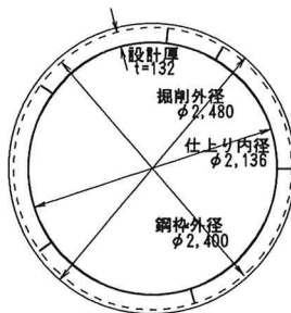
図-2 覆工断面図
