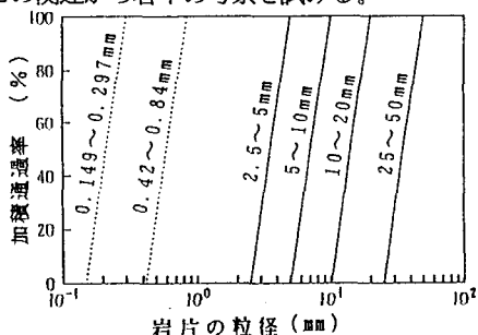
図-1 供試体を構成する岩片の粒度分布 表-2 供試体の初期間隙比
