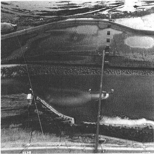
図-1 河道模型における橋脚周辺の局所洗掘
