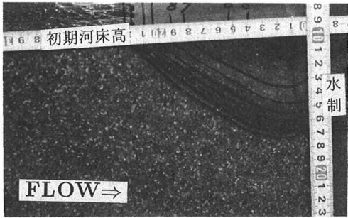
写-1 水制前域の局所洗掘（通水 50 分）
