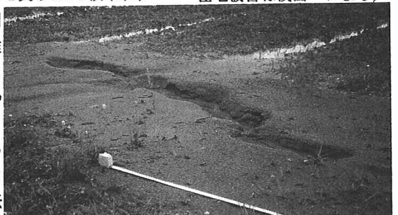
写真1 下牛潟の水田(休耕田)での噴砂(巻尺の長さ約1m)
