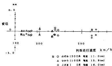
図-5 P8橋軸直角方向変位
