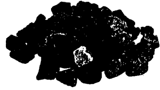
写真-2 粗骨材モデル(人工軽量骨材)
