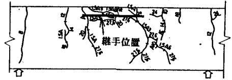
図-3 ひびわれ状況
