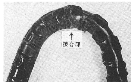
写真-2 曲げ試験後の外観
