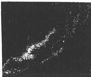
図3 アラミドT棒材の浸漬後断面（K分布、60℃アルカリ、0.65Pu、9000時間）
