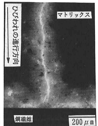
写真-2 鋼繊維付近のひびわれ
