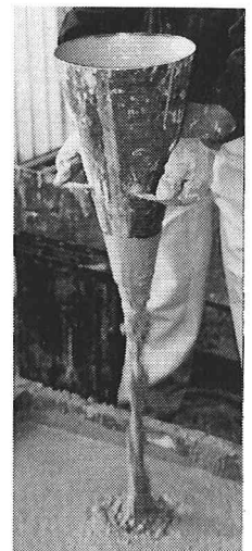
写真1 ロート試験状況
