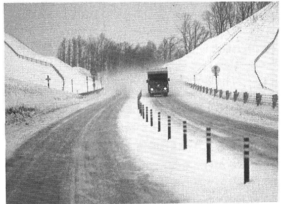
図-2, 大型トラックによる雪煙。雪煙の高さがほぼ車高と同じ。
