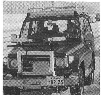
写真1車載型視程計を搭載した観測車
