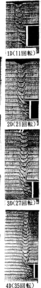
Fig.2 土被り変化による崩壊領域
