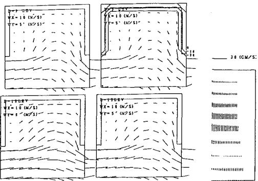
図-3 吹送流・潮流テストの流速ベクトルおよび中央部の流速の鉛直分布（底層、10、15 層および表層）
