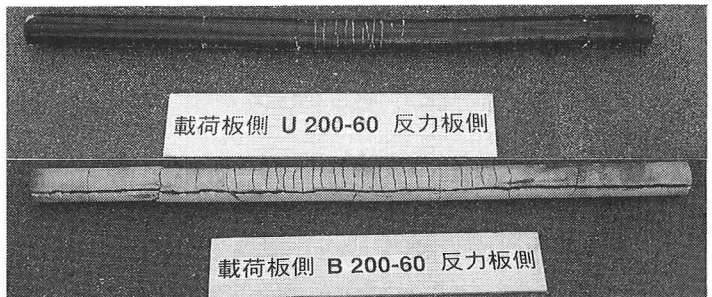
写真-3 モルタル崩壊状況（U200-60, B200-60）
