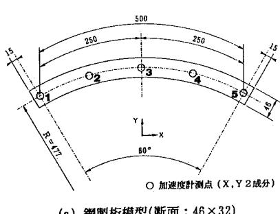
(a) 鋼製桁模型(断面; 46×32)
