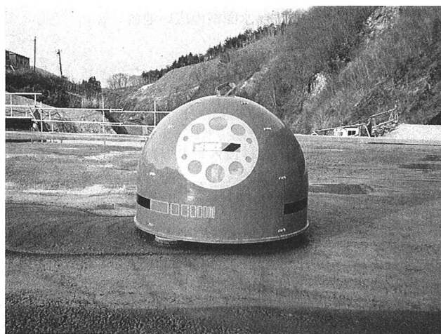
写真-1 ブラシ式グリーンカットロボット
