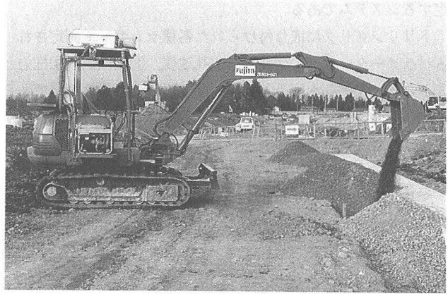
写真-2 バーチャルリアリティーによる遠隔制御
