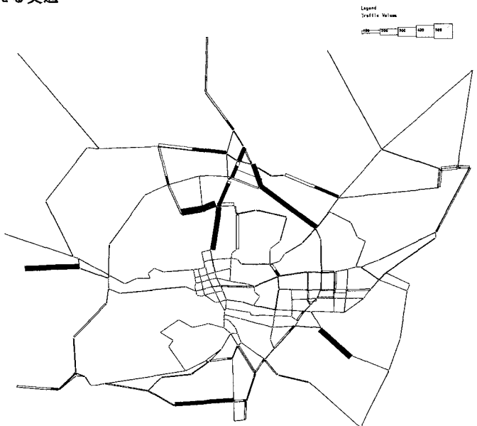
図-2 シミュレーション結果(7:30～7:45) (図中黒い部分は渋滞発生を示す)
