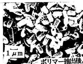
写真1 脱窒菌グラニュールのポリマー分泌状況（上）とポリマー抽出後（下）のSEM観察写真
