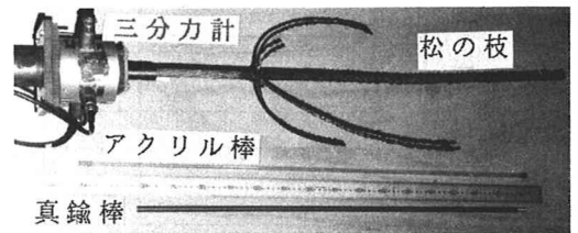
写真-1 松の小枝および試験円柱
