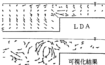
図-1 2次流ベクトルおよび横断面可視化結果
