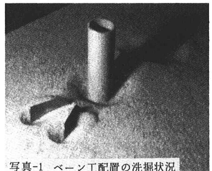
写真-1 ベーン工配置の洗掘状況
