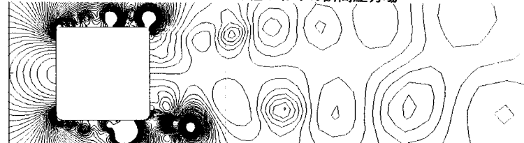
図-2 角に丸みを有する正方形柱まわりの瞬間圧力場
