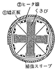
図4 装置断面構造（縮径）
