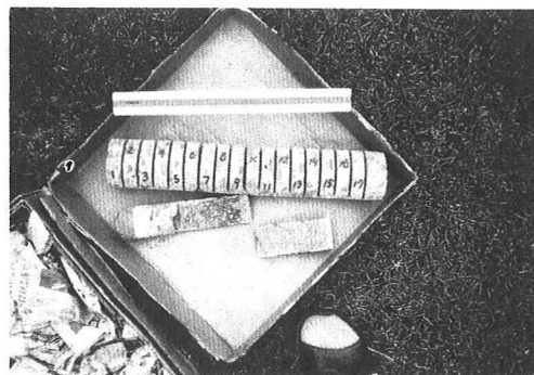
写真-2 切斷したコンクリートコア
