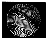
図-11 フイゾー干渉計によるシリコンウエハの形状測定縞図
