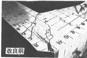
函断面載荷実験によるコーナー部の破壊形態
