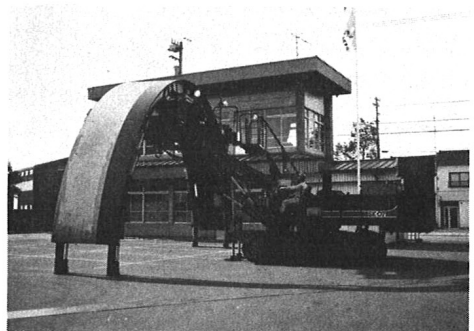
写真-1 CLiPセントルマシン
