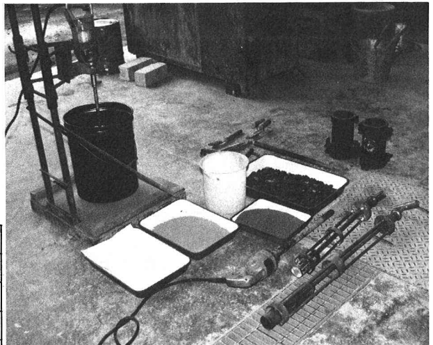
写真-1 使用器具類(ハンドミキサ、ペール缶、ランマー等)
