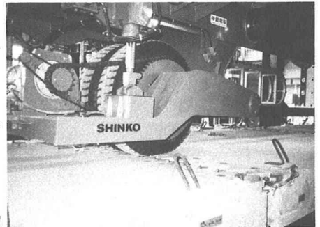
写真-1. 輪荷重移動載荷試験状況
