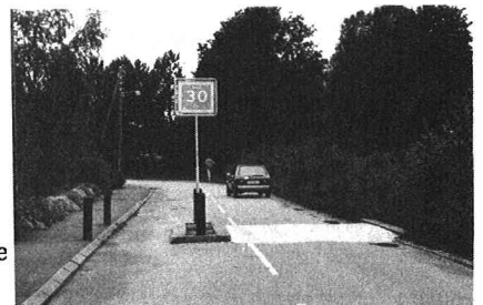
対面交通の道路で車線幅を1車線に狭め、ハンプを適用。片側には自転車の通行路を確保。 写真-1 Quiet Road の一例
