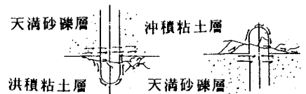
図-3 粘土層根入れ部凍土の融解
