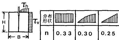
図-2 上下端面上のせん断応力分布
