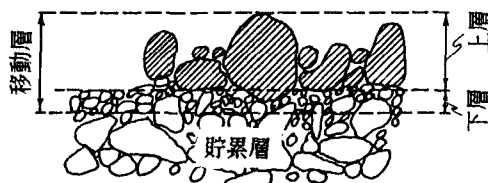
図-5 河床表層砂の鉛直分級概念図
