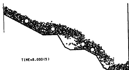
図-1 土石流の壁への衝突
