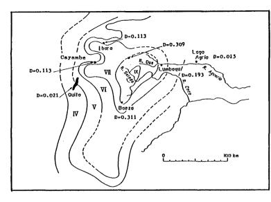
FIG. 4 DISTRIBUTION OF DAMAGE INDEX FOR THE 1987 ECUADOR EARTHQUAKE
