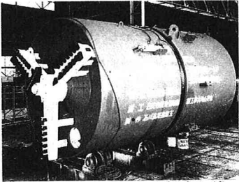
図-1 スライドフード押し出し前
