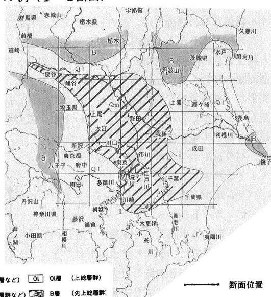
図-4 地質水平断面図の例 (標高 -200m)
