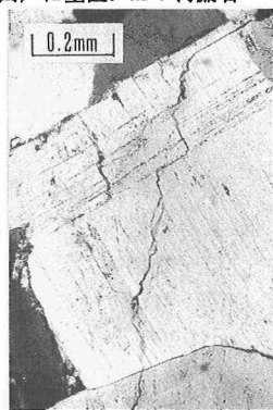
写真-2 長石粒内を進展するクラック。クラックは下端から上端へ向かう。
