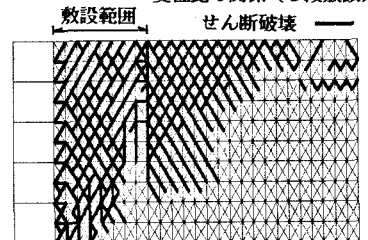
図-8 すべり線図 (Bタイプ, 9段敷設)
