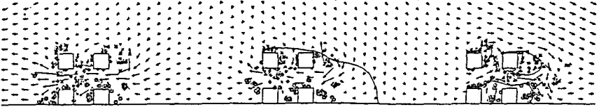
図-3 群体魚礁周辺の流況の計算結果 ( l_f/a=3 )
