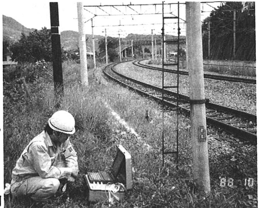
図-2 常時微動の測定状況
