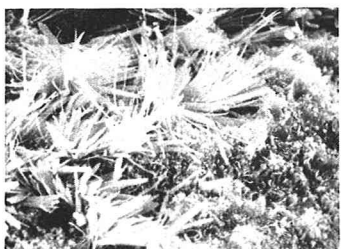
写真-4 砂岩 (0.2 N NaOH 3日)
