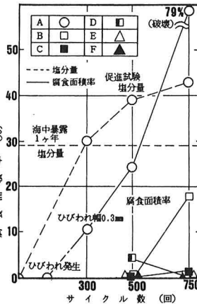
図-1 塩分量・腐食面積率の変化（促進試験）
